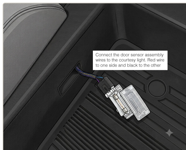
Fig. 5 — Door sensor assembly wiring
