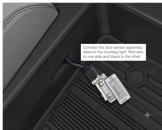
Fig. 5 — Door sensor assembly wiring
